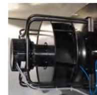
3 Ventilatori con motori EC e sistema integrato per la misurazione della portata volumetrica
