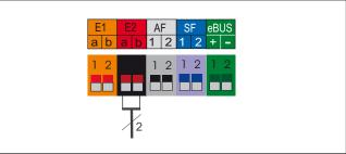
Fig.: Connecting input E2
