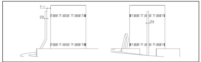
Fig.: Ionisation electrode gap
