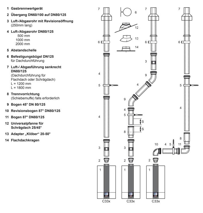
Art C33x: Gasbrennwertgerät mit Verbrennungsluftzu- und Abgasführung senkrecht über Dach.
