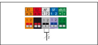
Bild: Anschluss Außenfühler
