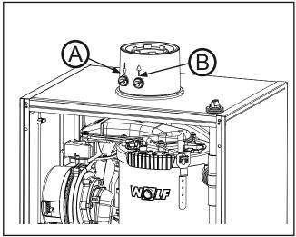
Fig.: Testing the flue gas parameters
