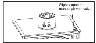
Fig.: Manual air vent valve
