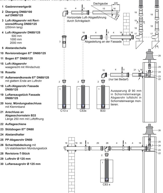
Die waagerechte Abgasführung ist mit ca. 3° Gefälle (6cm/m) zum Gerät zu montieren. Die waagerechte Luftführung ist mit ca. 3° Gefälle nach außen zu verlegen - Luftansaug mit Windschutz ausführen; zulässiger Winddruck am Lufteintritt 90 Pa, weil bei einem höheren Winddruck der Brenner nicht in Betrieb geht. Im Schacht kann nach dem Stützbogen (23) die Abgasleitung in DN80 verlegt werden. Eine flexible Abgasleitung DN83 kann nach dem Stützbogen (23) angeschlossen werden.
