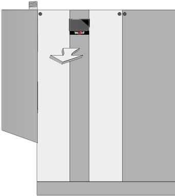
Frontpanel durch Lösen der vier Schrauben abmontieren.
