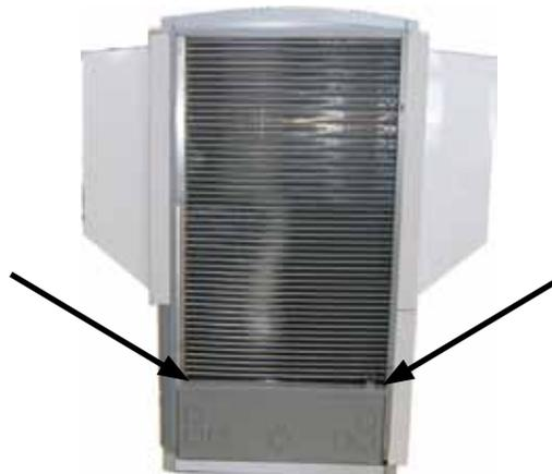
A través de las aberturas de inspección puede comprobarse la existencia de suciedad en la parte de expulsión de la bandeja de condensado y, en caso necesario, limpiarla.
