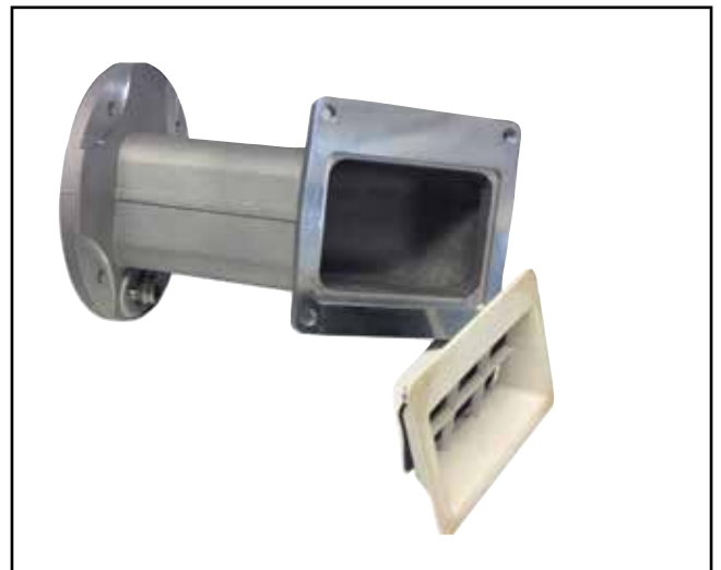
Bild: Sichtkontrolle Rückstromverhinderer
