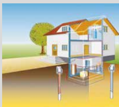
Anlagenschema - Förder- und Schluckbrunnen Wasser
